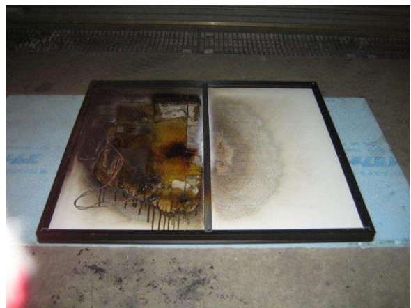
写真5-10 Test-5_A1 実験後裏面の状況
