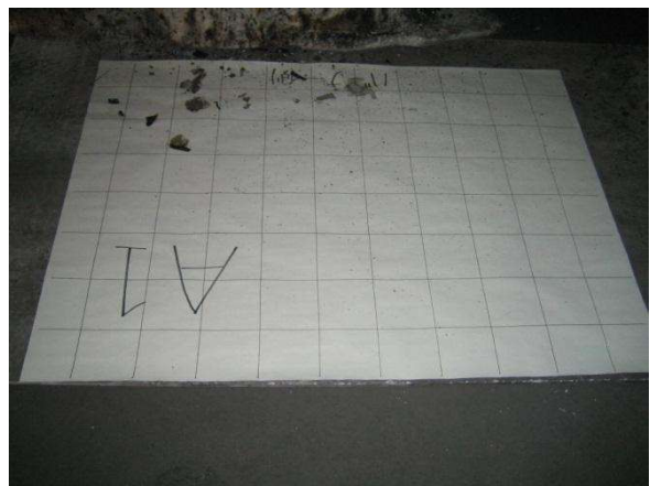
写真5-12 Test-5_A1 飛散物の状況
